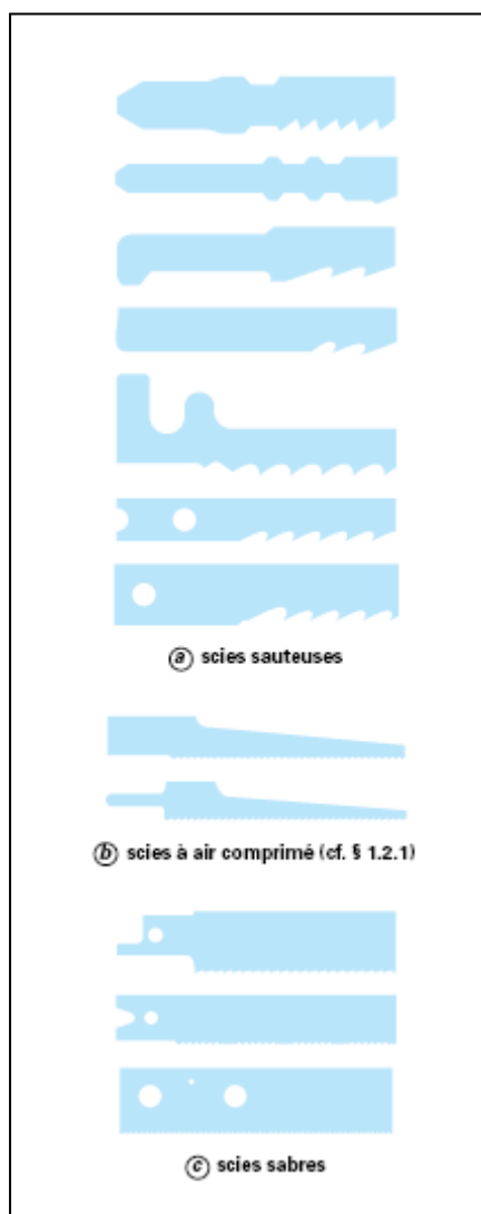
Figure 1 – Différentes attaches des lames de scies sauteuses et de scies sabres
