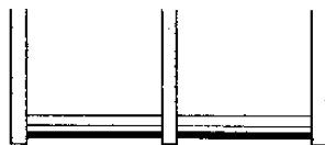
Coupe horizontale sur façade semi-rideau filante verticalement
