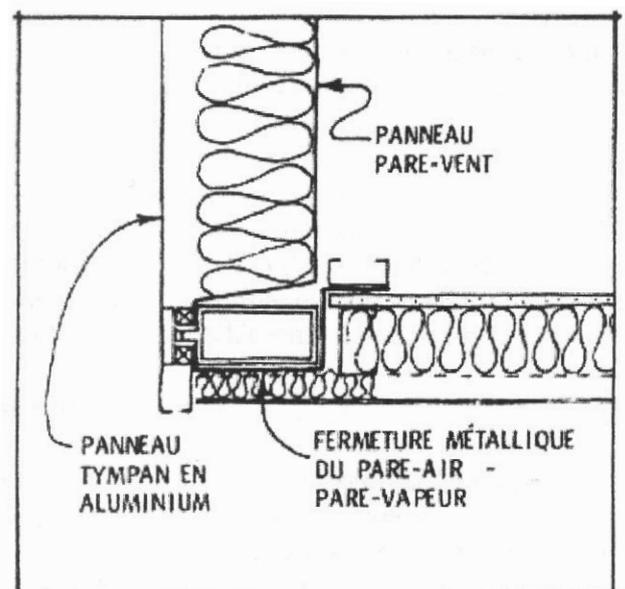
partie sous-jacente du soffite. Il faut ensuite prévoir une couche d'isolant continue qui s'étend du joint de coupure thermique du support, autour de ce même support, jusqu'à l'isolant du soffite.
