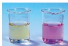
L'hélianthine est un indicateur coloré de pH. Sa couleur passe du jaune au rose lorsque la concentration en ion oxonium  $H_3O^+$  augmente.
