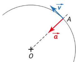
Dans le cas d'un mouvement circulaire uniforme, la vitesse est constante donc  $\frac{dv}{dt} = 0$  et  $a_t = 0$  donc :
