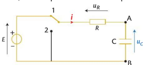
Un condensateur est initialement chargé tel que  $u_C = E$ , et l'interrupteur est en position 1.
