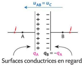
$$q_A \text{ en C} \rightarrow q_A = C \times u_C \left\{ \begin{array}{l} u_C \text{ en V} \\ \text{Capacité } C \text{ en F} \end{array} \right.$$
