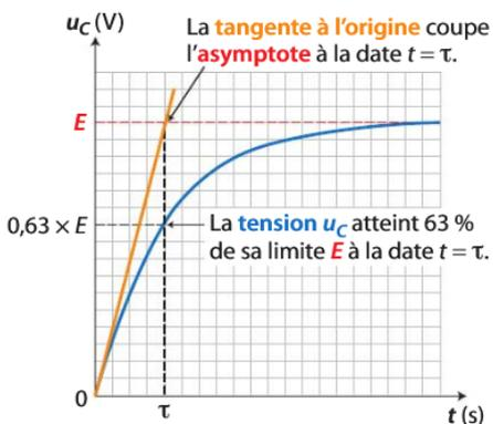
Détermination du temps caractéristique  $\tau = R \times C$  par exploitation graphique de la solution de l'équation différentielle
