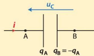
De plus, l'intensité du courant est la dérivée de la charge électrique  $q_A$  par rapport au temps :  $i = \frac{dq_A}{dt}$ .
