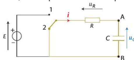
Établissement de l'équation différentielle vérifiée par la tension  $u_C(t)$  notée plus simplement  $u_C$
