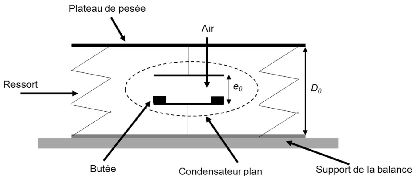
Lorsque la balance est à vide (sans masse sur le plateau), la distance entre les deux armatures est notée  $e_0$ . Lorsqu'un objet de masse  $M$  est posé sur le plateau de pesée, les armatures du condensateur se rapprochent, modifiant alors la valeur de sa capacité  $C$ . Les deux armatures ne peuvent pas entrer en contact grâce à la présence de petites butées de taille négligeable devant  $e_0$ .
