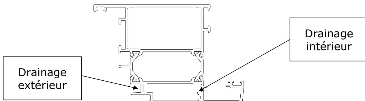
Pour le drainage de ces nouveaux ouvrants, il est nécessaire d'équiper le WU0021 par les butées EK7019
