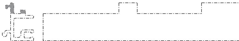
Usinage pour le passage du corps de penture supérieure **920024**
