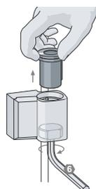
Soulever la douille PVC en vissant la douille de poussée et retirer-la.
