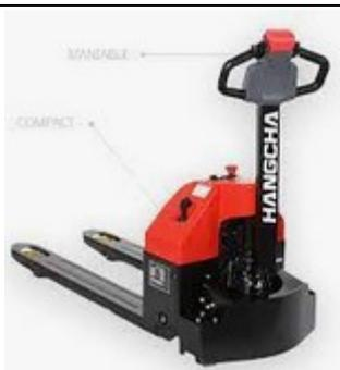
Transpalette électrique : est un outil de manutention idéal pour le déplacement au sol de charges palettisées. Il est équipé de deux fourches sur le devant, qui se glissent en-dessous de la palette afin de soulever la charge pour permettre son déplacement horizontal dans un entrepôt, un atelier.
